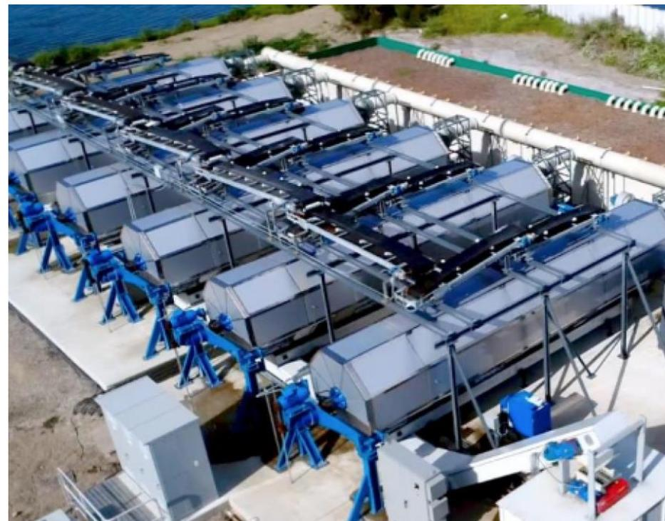
Il calore di scarto derivante dai processi metabolici dei batteri presenti nel fango porta la temperatura all'interno del reattore fino ai 65° C e, grazie ad una corretta insufflazione di aria e aspirazione del vapore acqueo, si ottiene in poche ore un abbattimento dell'**umidità** del fango fino al valore di **20%**
