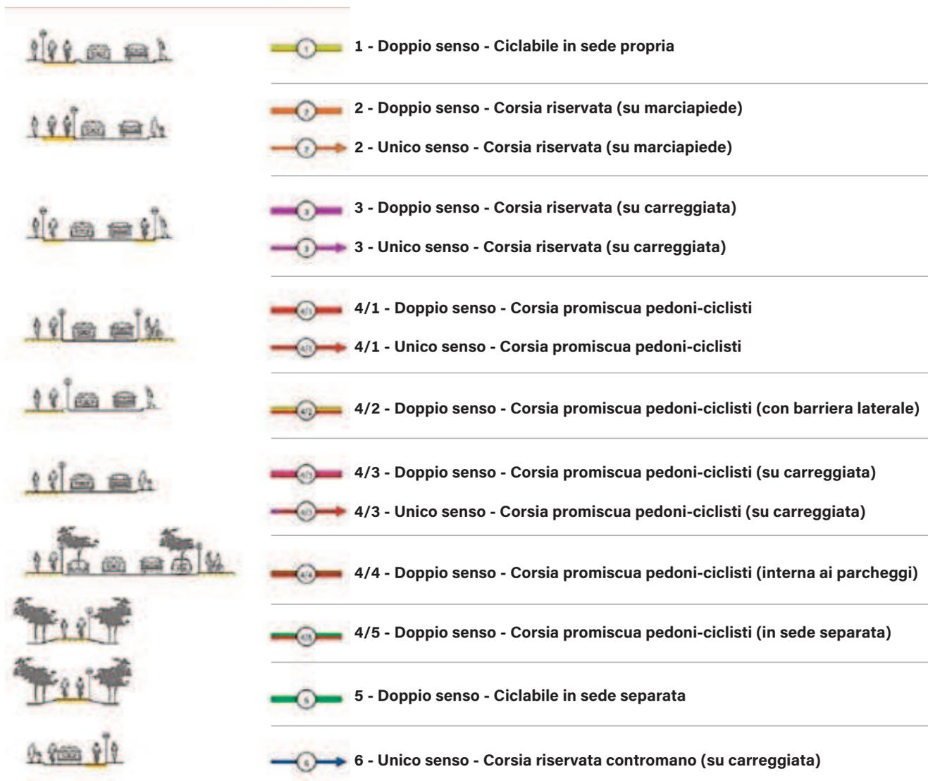
**Figura 2** | Schema delle sezioni stradali e delle tipologie di percorsi individuati durante l'attività di mappatura per il progetto Pianura Sostenibile (fonte: A. Nava, 2023).
